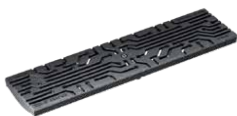
Støbejernsrist, WIRE Design, støbejern, KTL behandlet Belastningsklasse: D400* , Længde: 50 cm, SW 5 mm
