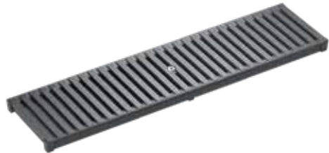
Rist, HEELGUARD, støbejern, sort lakeret Belastningsklasse: D400* , Længde: 50 cm, SW 6 mm
