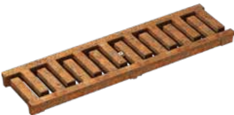
Rist, MASSIV 32, støbejern, ubehandlet Belastningsklasse: E600* , Længde: 50 cm, SW 11 mm Kun for KE-100.
