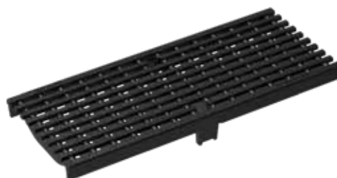
Spalter på langs rist, Støbejern GJS, KTL behandlet Belastningsklasse: D400*, E600* Længde: 50 cm, MW 25 x 11 mm
