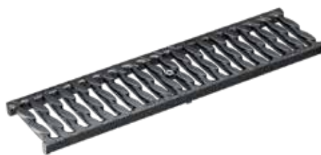
Rist, OvalGrip Design, støbejern, KTL behandlet Belastningsklasse: C250, E600* , Længde: 50 cm, SW 10 mm
