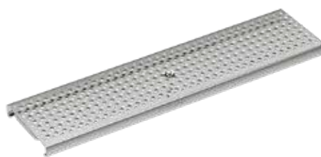
Perforeret rist, stål galvaniseret, rustfri Belastningsklasse: A15, C250 , Længde: 50 cm, 100 cm, Ø 6 mm
