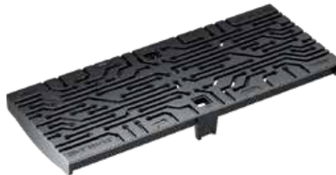
Støbejernsrist, WIRE Design, Støbejern GJS, KTL behandlet Belastningsklasse: D400* Længde: 50 cm, SW 5 mm
