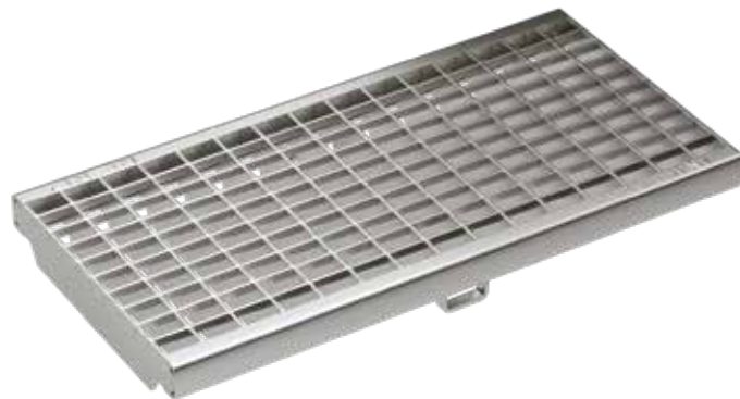
Maskerist, stål galvaniseret, rustfri Belastningsklasse: C250, D400* , Længde: 50 cm, 100 cm, MW 30 x 20 mm / 20 x 20 mm
