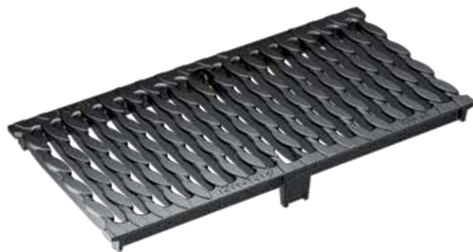
Støbejernsrist med OvalGrip Design, Støbejern GJS, KTL behandlet Belastningsklasse: D400*, E600* , Længde: 50 cm, SW 12 mm
