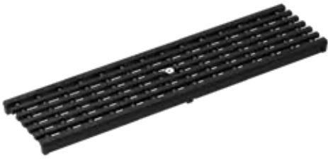
Spalter på langs rist, støbejern, KTL behandlet Belastningsklasse: D400* , Længde: 50 cm, MW 25 x 10 mm
