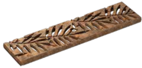
Designrist, LEAF, støbejern, ubehandlet Belastningsklasse: C250 , Længde: 50 cm, SW 5 - 9 mm
