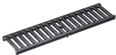
Rist SW 10, støbejern, KTL behandlet Belastningsklasse: C250 , Længde: 50 cm, SW 10 mm
